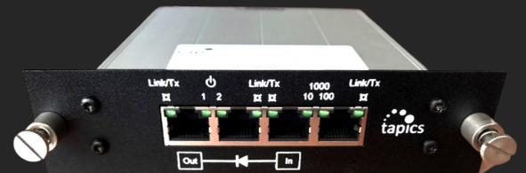
Diode cuivre interface ethernet RJ45 1 Gbps
